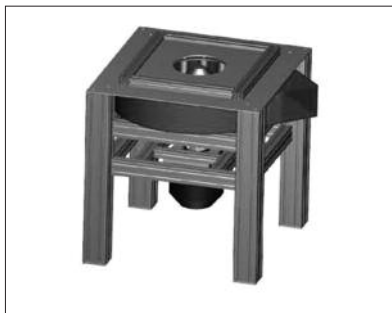
Spreuaufbereitungs- und Verteilvorrichtung
